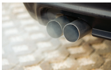
▲ Figura 20 Dal tubo di scarico degli autoveicoli alimentati a benzina e a gasolio escono anche piccole particelle di materia; la pericolosità di queste particelle è dovuta anche al fatto che sulla loro superficie sono adsorbite le molecole di sostanze pericolose come gli IPA .
