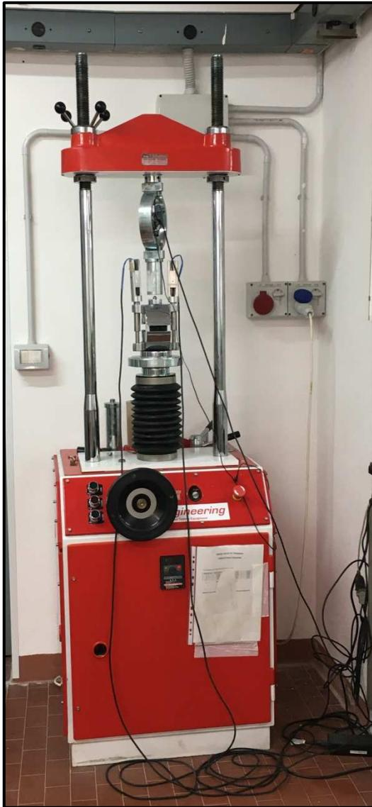
Macchina per misurare proprietà meccaniche di miscele bituminose confezionate a caldo con bitume e aggregati lapidei, sottoponendo a rottura provini cilindrici, confezionati con il compattatore.
