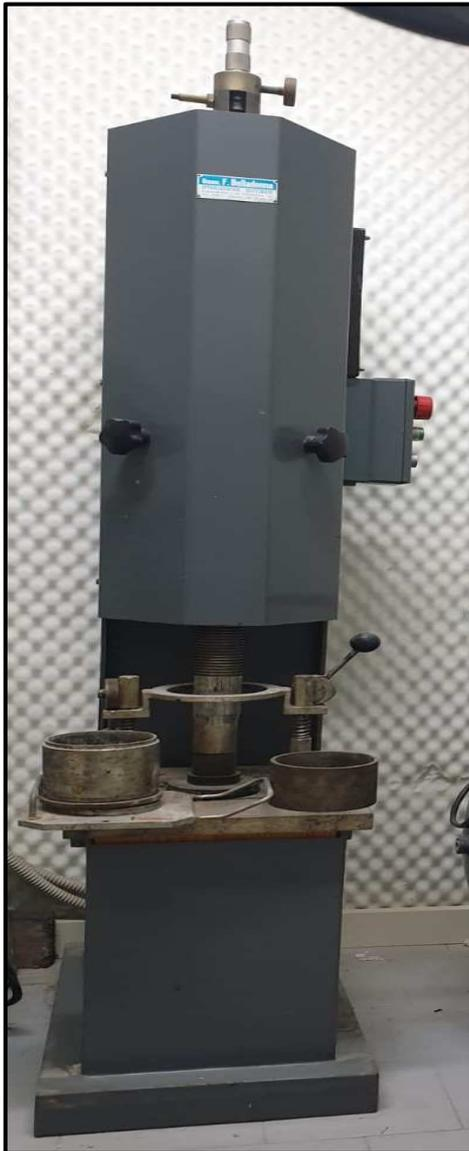
L'apparecchiatura consente di compattare il conglomerato bituminoso in camicie cilindriche per ottenere provini da impiegare in prove successive. Tramite un pestello azionato da una massa che cade ritmicamente, il materiale viene compattato in modo impulsivo (75 colpi su ogni base del provino cilindrico)
