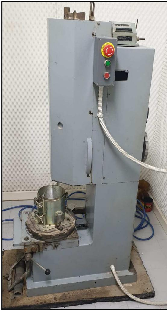
Per confezionare provini con miscele non legate e legate con leganti idraulici, costipando il materiale in modo impulsivo.
