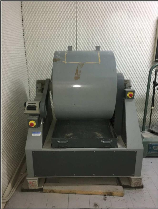
Utilizzata per determinare la resistenza alla frammentazione degli aggregati grossi
