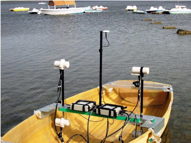
**Imbarcazione amagnetica utilizzata per l'acquisizione dei dati con due gradiometri Overhauser e con un sistema GPS differenziale**
