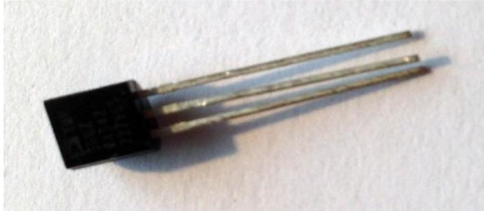
Componente elettronico a tre terminali che fornisce una tensione di uscita in funzione della temperatura esterna al componente secondo una formula matematica tipica del particolare sensore di temperatura. I piedini laterali vengono collegati alla tensione di alimentazione e a massa, mentre sul centrale viene rilevata la tensione proporzionale alla temperatura esterna.
