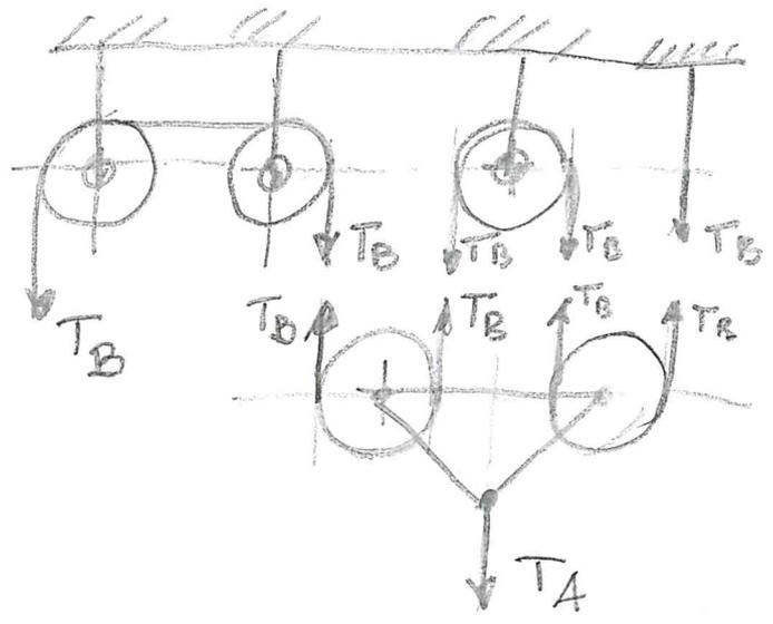
Calcolare l'accelerazione verticale  $a$  di un cilindro avente massa pari a  $150\text{kg}$  per ognuno dei due casi illustrati. Trascurare l'attrito e la massa delle pulegge. Nel caso B) è applicata alla fune una forza  $F=200 \cdot 9.81\text{ N}$ .
