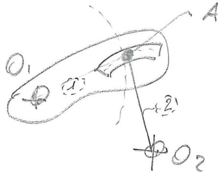
Il disco di figura , nell'istante considerato, ruota attorno ad O con velocità  $\omega = 4 \text{ rad/s}$  e accelerazione  $\dot{\omega} = -10 \text{ rad/s}^2$ .
