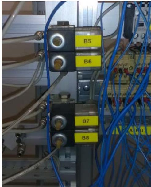
Figura 8: Elettrovalvole utilizzate
