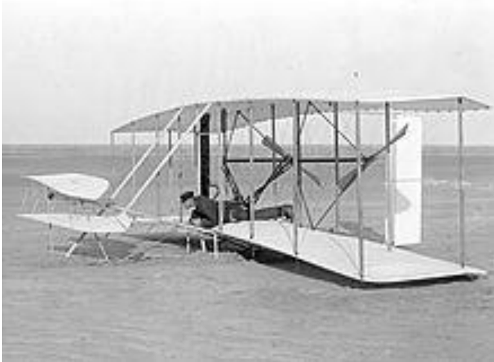
Flyer I (Motore autocostruito: potenza 12 CV, peso 81 kg)
