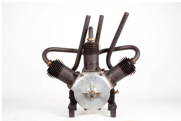
Motore Anzani a tre cilindri
