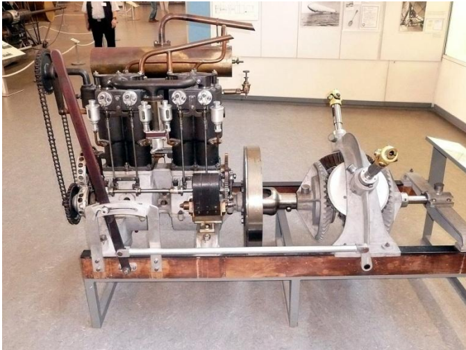
MOTORE DAIMLER 4-CILINDRI DA15 CV
