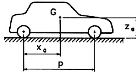
Il diagramma di corpo libero dell'autovettura è riportato in figura 1. Si noti che nel diagramma di corpo libero dell'autovettura non compare la coppia motrice quest'ultima, infatti, in questo diagramma è un'azione interna.
