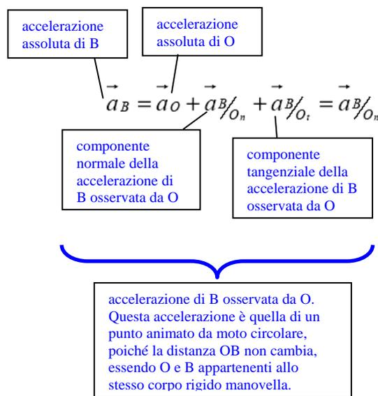
Si osservi che l'accelerazione  $\vec{a}_O$  è nulla poiché O è fermo e l'accelerazione  $a_{B/O_t} = \dot{\omega}_1 r = 0$  è nulla poiché la manovella ha accelerazione angolare nulla essendo  $\omega_1$  costante.
